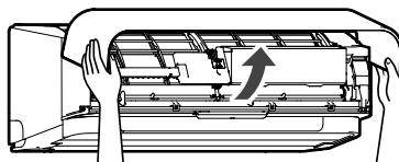
※前面パネルをさらに開くと、前面パネルを固定しているアームがはずれて落ちるおそれがあります。
