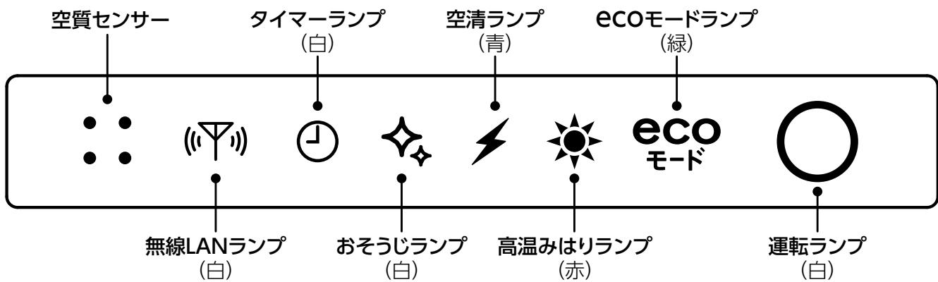
**高温みはりランプ** 高温みはりによる冷房運転中に点灯します。 **21ページ**
