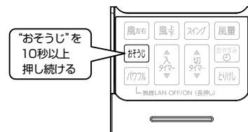
室内ユニットが受信すると、受信音♪ピッ♪が鳴り、その後、約6分間エアフィルターの動作確認を自動で行います。フィルター動作が正常に終了するとおそうじランプが消灯します。
