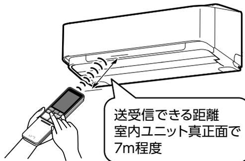
受信音が鳴り、運転ランプと空清ランプが点灯したら正しく送受信されています。 を押すと、受信音が鳴り運転が停止します。リモコンホルダーにリモコンを取り付けてお使いのときは、取付場所から信号が送受信されることを確認してください。
