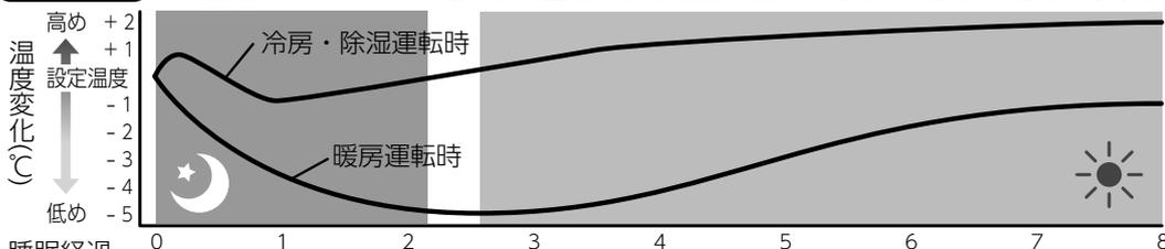
寝汗や寝冷えを抑えた心地よい睡眠ができるように時間の経過に合わせて温度をきめ細かく調整します。
