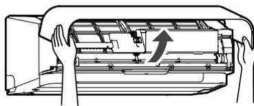
※前面パネルをさらに開くと、前面パネルを固定しているアームがはずれて落ちるおそれがあります。
