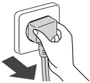
点検・お手入れの前には電源プラグを抜いてください。運転中はリモコンで運転を停止し、13分以上経ってから電源プラグを抜いてください。
