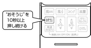
室内ユニットが受信すると、受信音♪ピットが鳴り、その後、約6分間エアフィルターの動作確認を自動で行います。フィルター動作が正常に終了するとおそうじランプが消灯します。
