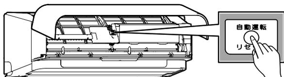
エアコンが停止し、室内ユニットから♪ピピピッ♪と音が鳴り、運転ランプが5秒間点滅します。
