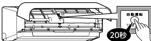
10秒後に♪ピッ♪と鳴り冷房運転になりますが、そのまま押し続けてください。♪ピッピッピッピッピッ♪と5回鳴り、運転ランプが点滅すると設定完了です。
