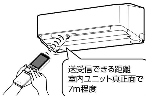
受信音が鳴り、運転ランプと空清ランプが点灯したら正しく送受信されています。
