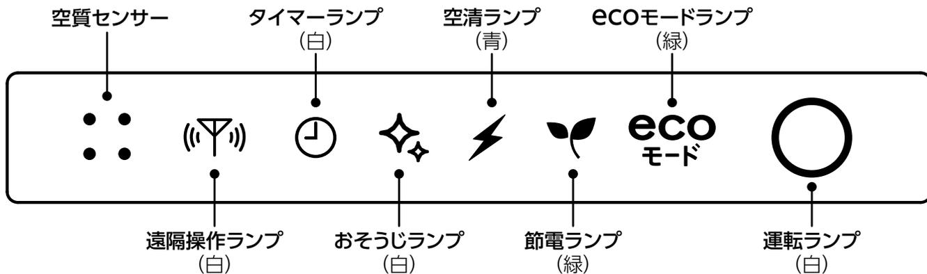
**節電ランプ** 節電冷房・節電暖房運転中に点灯します。 **12ページ**
