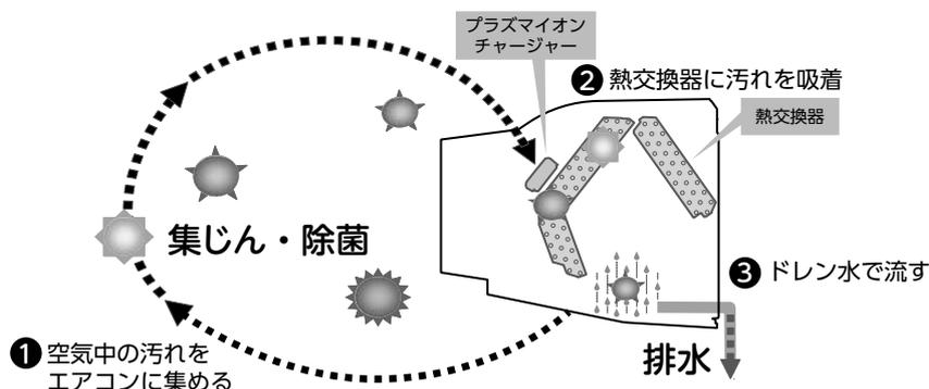
プラズマイオンチャージャー（空気清浄）で、空気をきれいにします。熱交換器に付着した汚れは、冷房・除湿運転時にドレン水で屋外に排出するので、お手入れは不要です。
