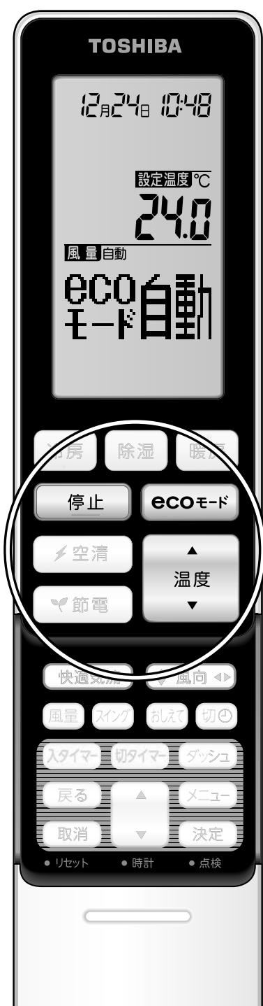
エアコンが運転の種類（冷房または暖房）を選んで運転します。同時に人サーチセンサー・明るさサーチセンサーで、省エネ・節電運転を行います。
