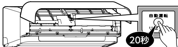
10秒後に♪ピッ♪と鳴り冷房運転になりますが、そのまま押し続けてください。♪ピッピッピッピッピッピッ♪と5回鳴り、運転ランプが点滅すると設定完了です。
