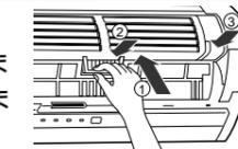
集じんユニット両側の突起部が受部(ツメ)に完全に入るまで、の方向に集じんユニット両端を押しします。
