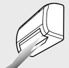
暖房時は『斜め下吹き』です。暖房のまろやか運転時、設定温度と部屋の温度が近づいたとき、または運転開始後約30分以後『水平吹き』になります。自動運転時に、暖房が選択されているときは『斜め下吹き』です。
