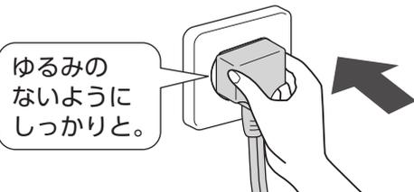
電源プラグをコンセントに差し込んだ後、運転準備に3～8分かかります。この間はリモコンの信号を受信し、運転ランプなどが点灯しますが、運転は開始しません。
