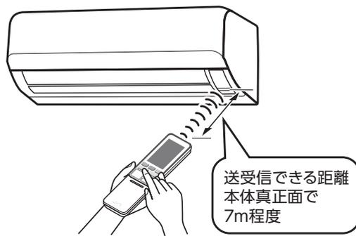
受信音が鳴り、運転ランプと空清ランプが点灯したら正しく送受信されています。**停止** を押すと、受信音が鳴り運転が停止します。リモコンホルダーにリモコンを取り付けてお使いのときは、取付場所から信号が送受信されることを確認してください。
