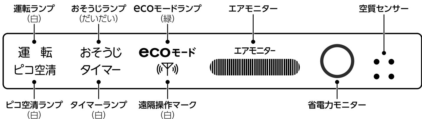
**エアモニター** ピコイオン空清運転時、お部屋の空気の汚れ具合を空質センサーで検出し、空気のきれいさに応じて点灯数を変えます。 **17ページ**
