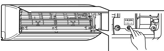
エアコンが停止し、室内ユニットから♪ピピピッ♪と音が鳴り、タイマーランプが5秒間点滅し、室内ユニット表示部の遠隔操作マーク(□)が点灯します。(HAアダプタが正しく接続されていないときは、点灯しません。)
