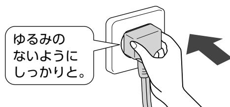
電源プラグをコンセントに差し込んだ後、運転準備に3～8分間かかります。この間はリモコンの信号を受信し、運転ランプなどは点灯しますが、運転は開始しません。
