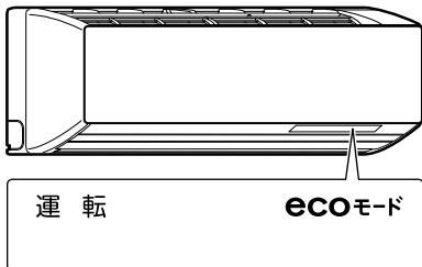
エアコンが運転の種類（冷房または暖房）を選んで運転します。同時に人サーチセンサー・明るさサーチセンサーで、省エネ・節電運転を行います。
