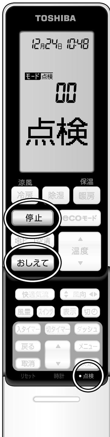
リモコンで運転を停止し一度電源プラグを抜き、30秒後にもう一度差し込み、運転をします。
