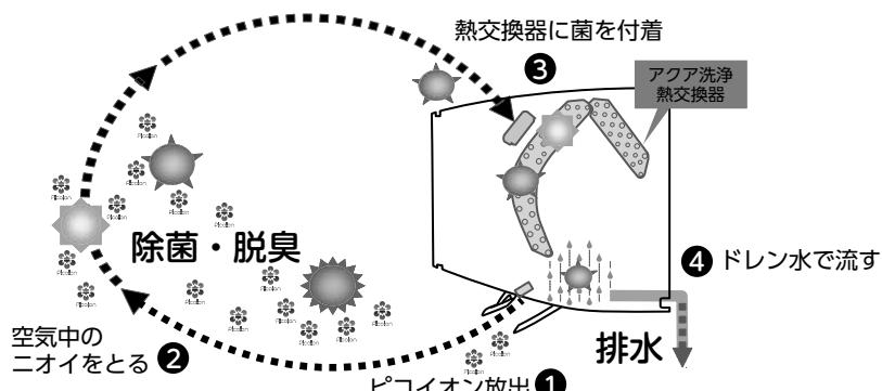
プラズマイオンチャージャー(空気清浄)とピコイオンで、空気をきれいにします。エアコン内部に集めた汚れは、冷房・除湿シーズンにドレン水で屋外に排水するので、お手入れは不要です。また、空気中に放出したピコイオンでニオイを脱臭します。
