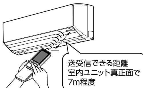
受信音が鳴り、運転ランプが点灯したら正しく送受信されています。
