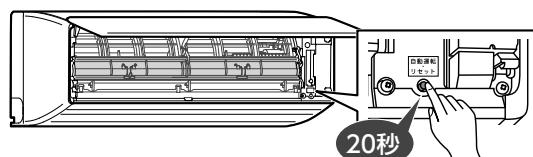
10秒後に♪ピッ♪と鳴り冷房運転になりますが、そのまま押し続けてください。♪ピッピッピッピッピッピッ♪と5回鳴り、運転ランプが点滅すると設定完了です。
