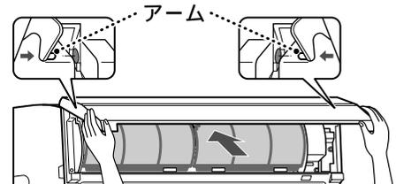
**2** 前面パネルを下方に下げ、4カ所を押して閉める
