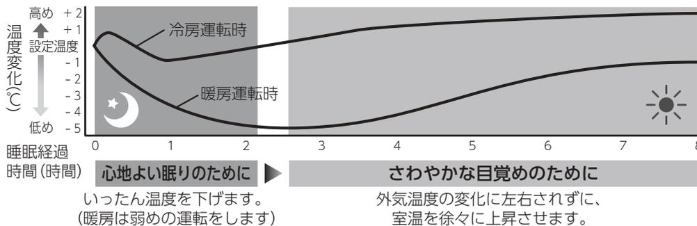
寝汗や寝冷えを抑えた心地よい睡眠ができるように時間の経過に合わせて温度をきめ細かく調整します。
