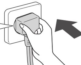
電源プラグをコンセントに差し込んだ後、運転準備に3～8分かかります。この間はリモコンの信号を受信し、運転ランプなどが点灯しますが、運転は開始しません。
