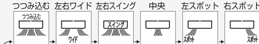
●冷房時、冷風感を求める場合は、「中央」「左スポット」「右スポット」などで、人のいる方向に風向を設定してください。
