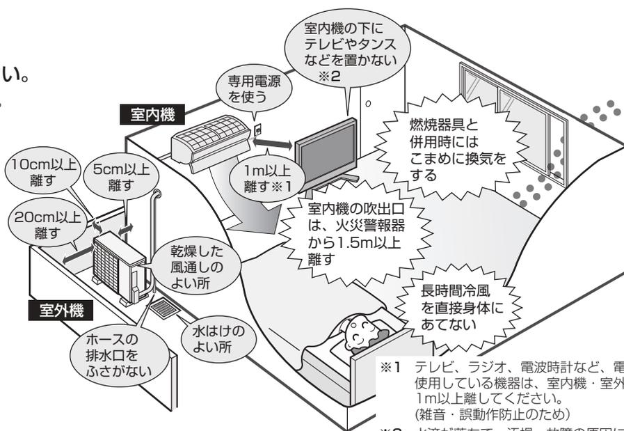
※1 テレビ、ラジオ、電波時計など、電波を使用している機器は、室内機・室外機から1m以上離してください。
