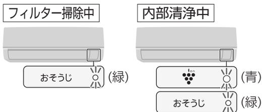
「フィルター掃除」、「内部清浄」は、停止中に手動で運転できます。
