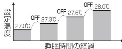
室温の上がりすぎ、下がりすぎを防ぐため、設定温度を徐々に変化させ、快適な目覚めをサポートします。また、周期的に運転をOFFさせてムダな電気代を抑えます。
