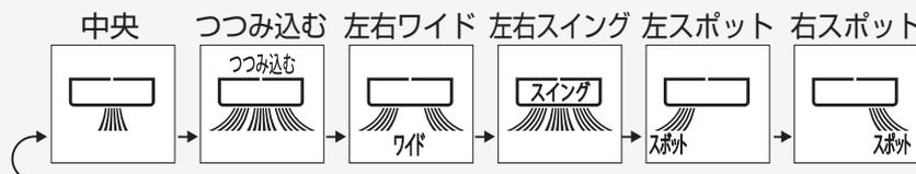
●冷房時、冷風感を求めたい場合は、「中央」「左スポット」「右スポット」などで、人のいる方向に風向を設定してください。
