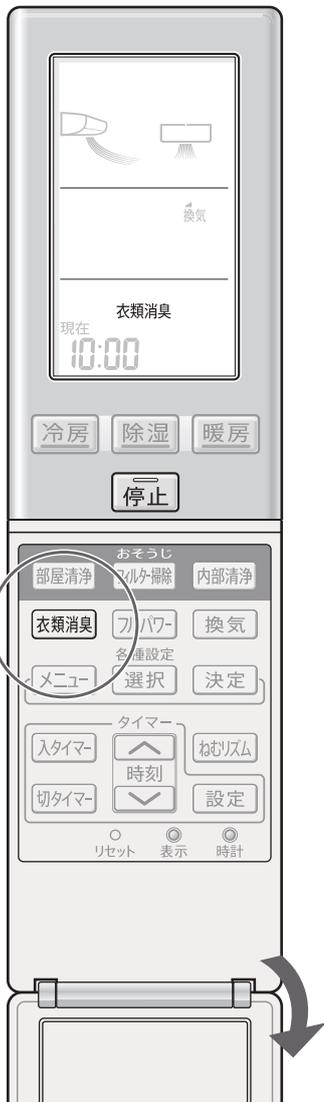
プラズマクラスターイオンで、衣類に付着したタバコなどの嫌なニオイを軽減します。衣類に風がよくあたるように、風向を以下の種類の中で調節してください。
