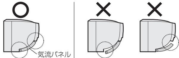
ご注意 オープンパネル、気流パネルは、分解しないでください。(破損・故障の原因)
