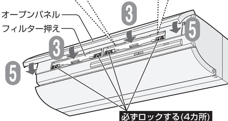
5 「オープンパネル」の左右両端を「カチッ」と音がするまで、確実に閉じる。
