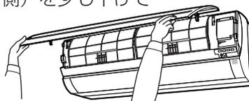
②パネルの支点を本体の支持部に合わせて押し込む。
