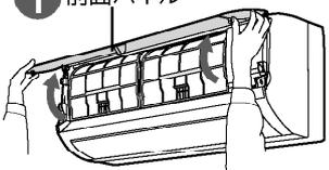
前面パネル開閉部(左右)に指をかけ、“カクッ”と音がするまで、ゆっくり引き上げる。(水平より下向きで止まります)
