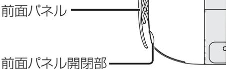
停止時に、前面パネルを勢いよく閉じると、前面パネルが浮く場合があります。そのような場合は、前面パネル開閉部を持って、もう一度ゆっくりと開閉してください。
