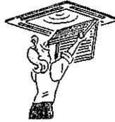
(2) 室内・室外ユニットの吹出口・吸込口が塞がれていないことを確認する。
