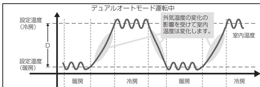
※ 冷房設定温度と暖房設定温度の差 (D) の最小値は、接続する室内ユニットにより異なります。
