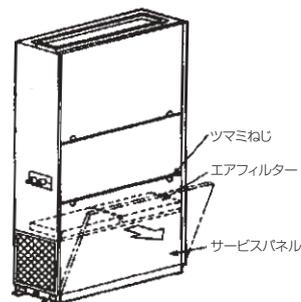
3. 清掃後、元に戻すときエアフィルターについている耳をフィルターガイドに挿入する。
