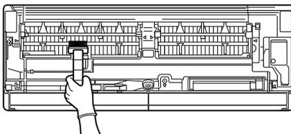
あらかじめ、ダストボックス、抗菌・金属コートフィルター、帯電マイクロフィルター、アレル除菌脱臭空清フィルターは取外しておく。
