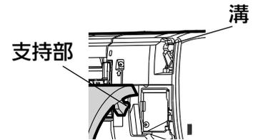
前面パネルの支持部を両手で持ち、矢印の方向から支持部が“カチッ”と音がするまで溝に差込みます。
