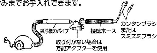
専用以外のものを使用すると金属部（熱交換器）などの破損の原因となりますのでご使用をおやめください。
