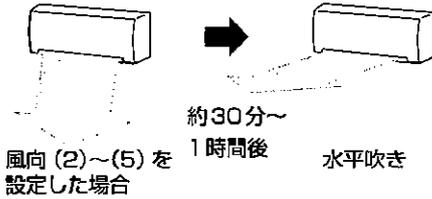
暖房運転開始時や霜取り運転中などは、冷たい風が体に直接当たるのを防止するために水平吹きになり、微風運転になります。
