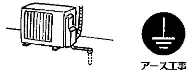
据付場所（水気のある場所など）によっては、漏電遮断器を取付ける
