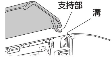
前面パネルの支持部を両手で持ち、矢印の方向から支持部が“カチッ”と音がするまで溝に差込みます。
