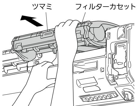
※フィルターカセットを引き出すとき、格子の間に指を入れてフィルターを破らないようしてください。
