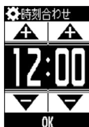
時刻合わせ画面が表示されます。▲▼で時刻を合わせてOKをタッチします。
