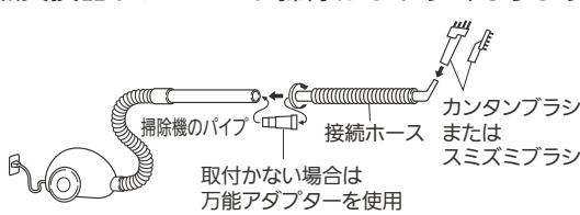
専用以外のものを使用すると金属部(熱交換器)などの破損の原因となりますので、専用ブラシを使うことをおすすめします。
