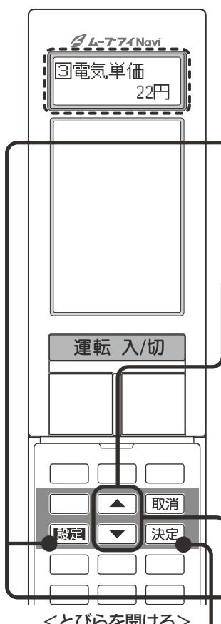
電気代の算出に用いる電気代の単価を設定できます。時間帯に関係なく一定の単価を設定する「通常」モードと、時間帯別に単価を設定する「オール電化」モードがあります。
