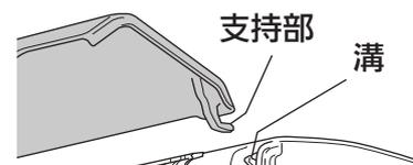
前面パネルの支持部を両手で持ち、矢印の方向から支持部が“カチッ”と音がするまで溝に差込みます。
