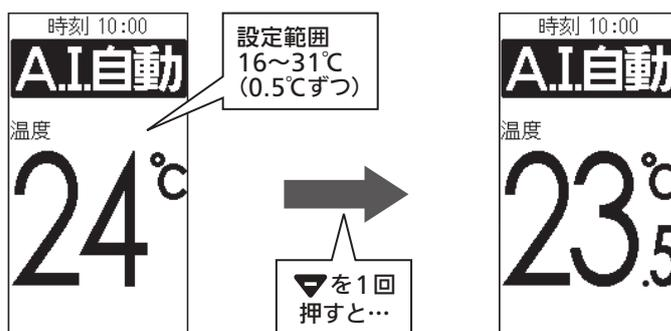
● 温度の調節は1回押しで0.5°Cずつ変化します。押し続けると0.5°Cずつ続けて変化します。
