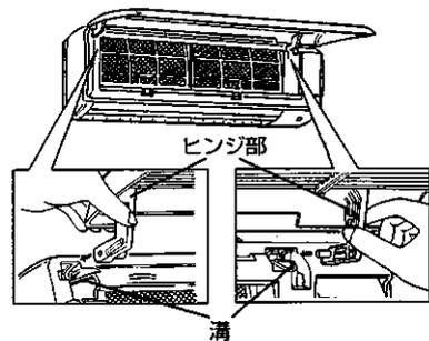
2 両手で丸洗いパネルの両端を持って閉じる。丸洗いパネルの両端と中央を押す。
