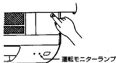
室内機の運転モニターランプを用いて運転内容を表示します。
