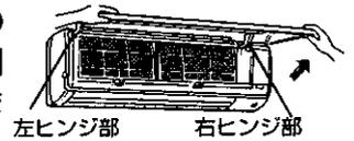
2 片手で丸洗いパネルをささえながら室内機の右端最上部のつまみを矢印方向に押しつけたまま、右ヒンジ部を手前に取外す。
