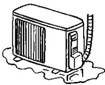
■冷房時に、冷えた配管や配管接続部に水滴がつき、滴下するためです。
