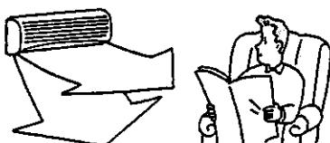
風上下 自動では冷房運転のとき水平吹出し、暖房運転のとき下吹出し
