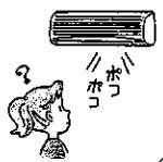
■レンジフードや換気扇を回したとき排水用ホースから室外の空気を吸込み、ホース内の水を吹上げるときに出る音です。
