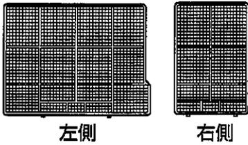
①両手で丸洗いパネルをつかみ、側面のツマミに指を掛け手前に引いて、ツメを外してから丸洗いパネルを開ける。
