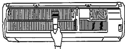
■エアフィルター、プラズマ脱臭ユニットを外した後、熱交換器のお手入れをしてください。
