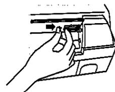
上下風向フラップの取付け形状を確認してください。“カチッ”と止まる位置まで緑の安心ストッパーを挿入する。
