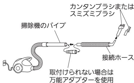
※万能アダプターは、掃除機のパイプ内径29.5~42.5(mm)に対応しています。掃除機の機種によっては、万能アダプターが取付けられない場合があります。
