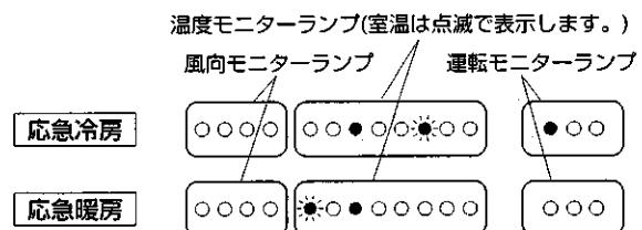
停止のときは温度モニターランプと運転モニターランプがともに消灯します。
