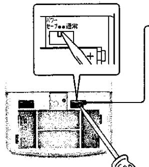
リモコンの裏バタを開けて、パワーセレクトスイッチのつまみをパワーセーブの位置にする。
