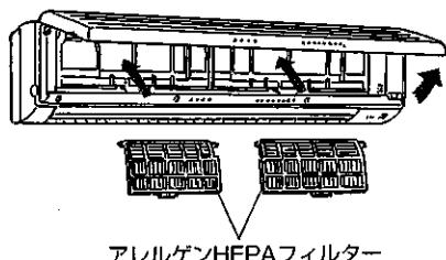
●アレルゲンHEPAフィルターは小さい方を左側へ大きい方を右側へ取付けてください。
