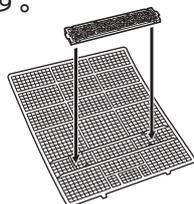
②防カビエアフィルターの爪部を室内機に確実にはめ、取付けます。
