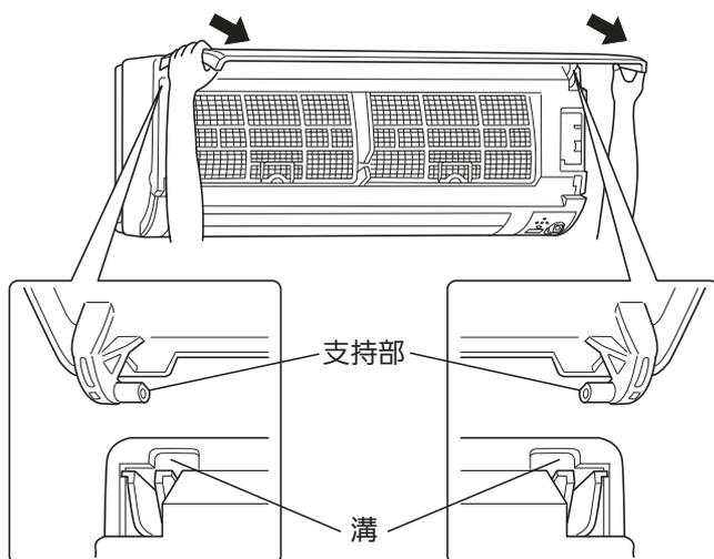
▶▶ 前面パネルは無理に引抜いたり、落下させないでください。前面パネル破損の原因になります。
