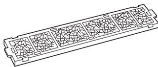
①フィルター枠からフィルターを外さずにつけ置き洗いをします。
