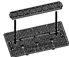
エアフィルターの爪部を室内機に確実にはめ、取付ける。
