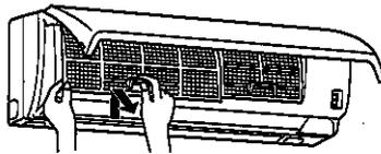
アレル・除菌フィルターの格子側を上にして、エアフィルターに押込むように10カ所の爪部を掛ける。
