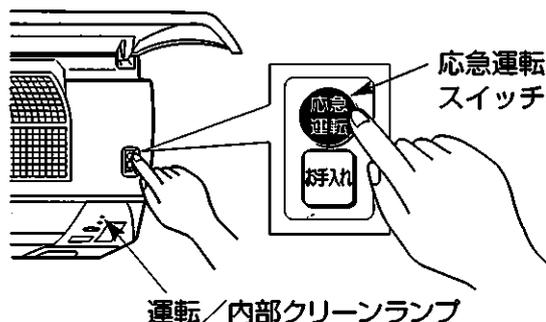
室内機の運転/内部クリーンランプを用いて運転内容を表示します。
