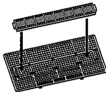
エアフィルターの爪部を室内機に確実にはめ、取付ける。
