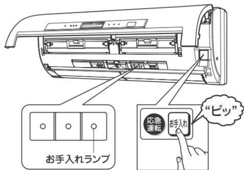
お手入れスイッチを押すと、エアフィルターの送り出し/巻き戻しが自動で行われ、取り付けられた状態を確認します。（フィルター清掃ランプ点灯）
