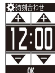
時刻合わせ画面が表示されます。**▲▼**で時刻を合わせて**OK**をタッチします。**Wi-Fi**
