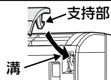
丸洗いパネルを両手で持ち、矢印の方向から支持部が“カチッ”と音がするまで溝に差込みます。
