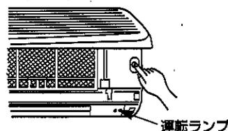
室内機の運転ランプの緑色と内部乾燥ランプのオレンジ色を用いて運転内容を表示します。
