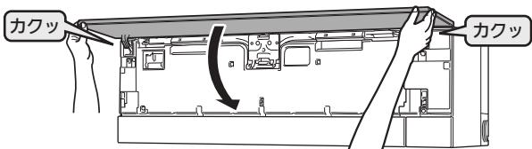
前面パネルの支持部を両手で持ち、矢印の方向から支持部が“カチッ”と音がするまで溝に差込みます。
