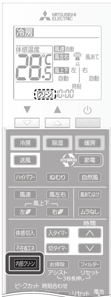
運転を開始したときは、いやなニオイを抑制する「スタート脱臭」を行います。運転を停止したあとは、エアコン内部※を乾かし、内部を清潔に保つ「内部クリーン」を行います。
