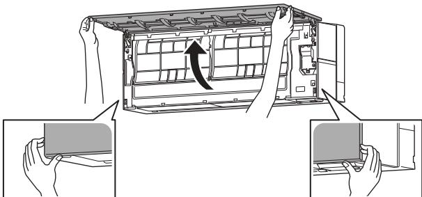
3 前面パネル裏のストッパーを、「カクッ」と手応えがあるまで回転させ、ストッパーの先端を室内機の凹部に入れる。
