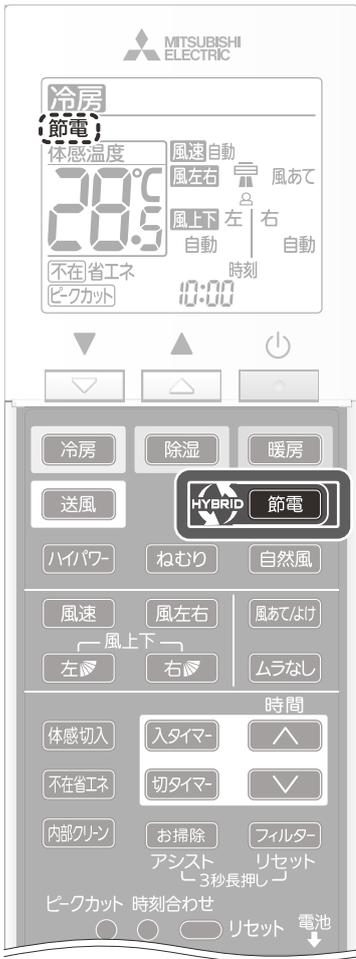
感じる快適をそのままに、風向、風速を最適にコントロールして節電運転※1を行います。
