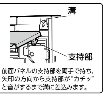
前面パネルの支持部を両手で持ち、矢印の方向から支持部が“カチッ”と音がするまで溝に差込みます。
