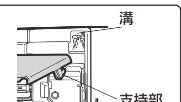
前面パネルの支持部を両手で持ち、矢印の方向から支持部が“カチッ”と音がするまで溝に差込みます。
