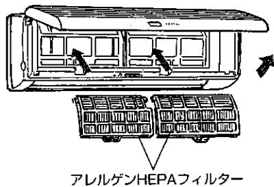
●アレルゲンHEPAフィルターは小さい方を左側へ大きい方を右側へ取付けてください。
