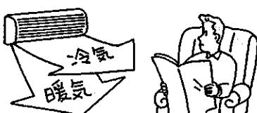
●自動では冷房運転は水平吹出し、暖房運転は下吹出し
