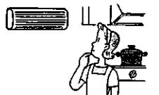
■換気扇やガスコンロを使用する部屋では、冷房負荷が大きくなり、冷えが悪い場合があります。
