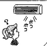
■レンジフードや換気扇を回したとき排水用ホースから室外の空気を吸込み、ホース内の水を吹上げるときに出る音です。
