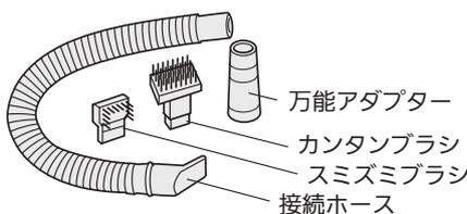
専用以外のものを使用すると金属部(熱交換器)などの破損の原因となりますので、専用ブラシを使うことをおすすめします。詳細は専用おそうじカンタンセットの取扱説明書をご覧ください。
