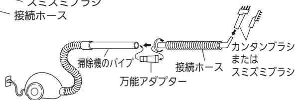
※万能アダプターは、掃除機のパイプ内径φ32~39(mm)に対応しています。掃除機の種類によっては、万能アダプターが取付けられない場合があります。
