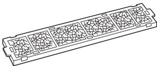
①フィルター枠からフィルターを外さずにつけ置き洗いをする。
