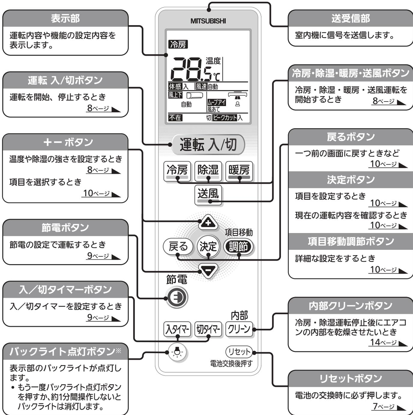
※バックライト点灯ボタンは暗い場所で発光します。光り方が弱いときは、しばらく明るい場所に置いてから使用してください。
