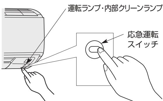
室内機の運転ランプと内部クリーンランプを用いて運転内容を表示します。
