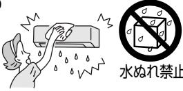
お手入れをするときは必ず運転を停止し、電源プラグを抜くか、ブレーカーを切る
