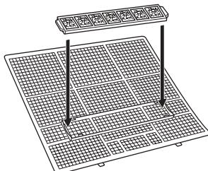
エアフィルターの爪部を室内機に確実にはめ、取り付ける。
