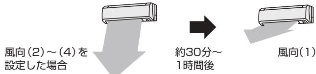
暖房運転開始時や霜取り運転中などは、冷たい風が体に直接当たるのを防止するために水平吹きになり、微風運転になります。
