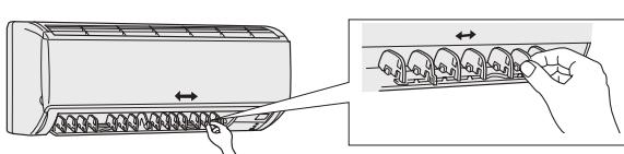
手で上図のように上下風向フラップを開き、両端から2つ目の左右風向フラップを持って、変えたい風向きに動かしてください。
